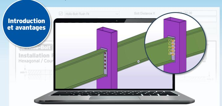
L'« Add-on Boulon » et l'« Assemblage macro avec platine d'extrémité » de Lindapter ont été mis au point en collaboration avec Tekla Structures pour gagner du temps et offrir un moyen efficace et précis de conception détaillée des Hollo-Bolts, en éliminant les erreurs de spécifications liées à la saisie de dimensions erronées pour les boulons et les perçages.
