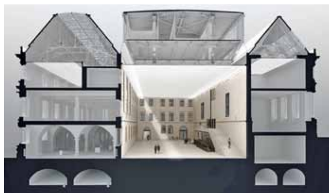
Bild 2. Nicht der Neubau des schwebenden Depots, sondern dieser für das Museum so wichtige neue Raum sollte im Zentrum der Aufmerksamkeit der Besucher stehen – mit der Konsequenz, den Neubau als ein beinahe unsichtbares Gebäude über den Hof zu legen © Staab ARCHITEKTEN
